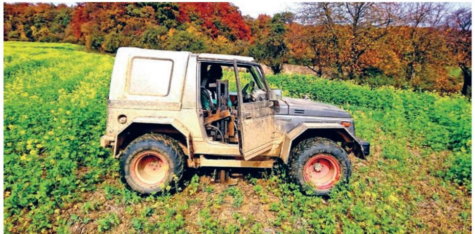
Einsatz eines modifizierten Geländewagens bei der Entnahme von Bodenproben auf einem Ackerschlag im Wasserschutzgebiet.
